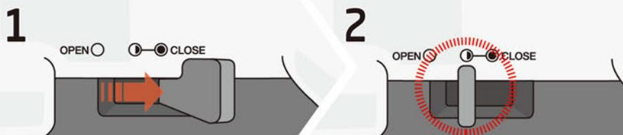
1. Veuillez mettre le levier sur la position **●** CLOSE (fermée) avant de procéder à l'extraction des ingrédients.
